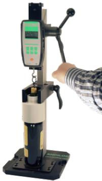
L'Extractor II est un système simple et très pratique pour mesurer de façon répétitive et rapide la force d'arrachement ou d'extraction des bouchons de bouteilles de vins.
