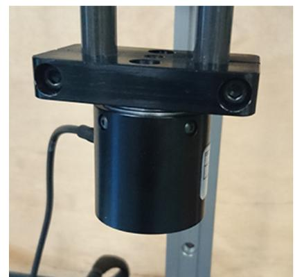
Capteurs de couple interchangeables de 0.15 à 12 Nm.
